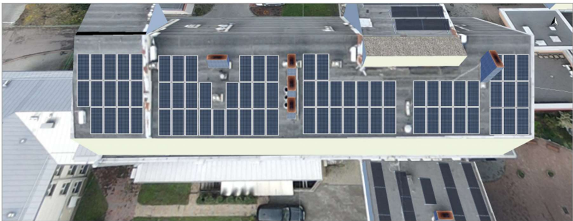
Ilustracja: 4. Powierzchnię modułu - 42,16 KW DACH1-Powierzchnia dachu Południe
